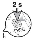
Appui de 2 secondes sur « PROG » à partir d'une commande de volet qui est déjà programmée au moteur.
