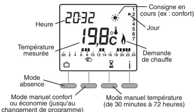
A la mise en service, la température mesurée par le thermostat s'affiche (le symbole apparaît au-dessus du °C).
