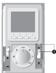
Fixez le thermostat à l'aide de vis et de chevilles ou sur une boîte d'encastrement (1, entraxe 60 mm).
